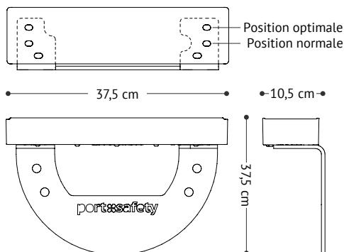
Le Wallmount (Support Mural) est un complément optionnel en acier inoxydable A4 316 de 6 mm. Utilisez des fixations M12 appropriées pour l'installer.
